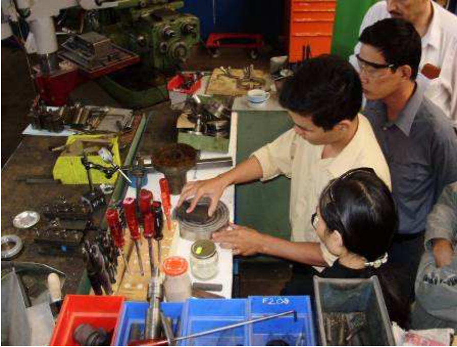
Photo: Nun den Abziehstein sauber putzen mit dem Petrol und Quarzsand 0,1 mm war wichtig für einen guten Stein
