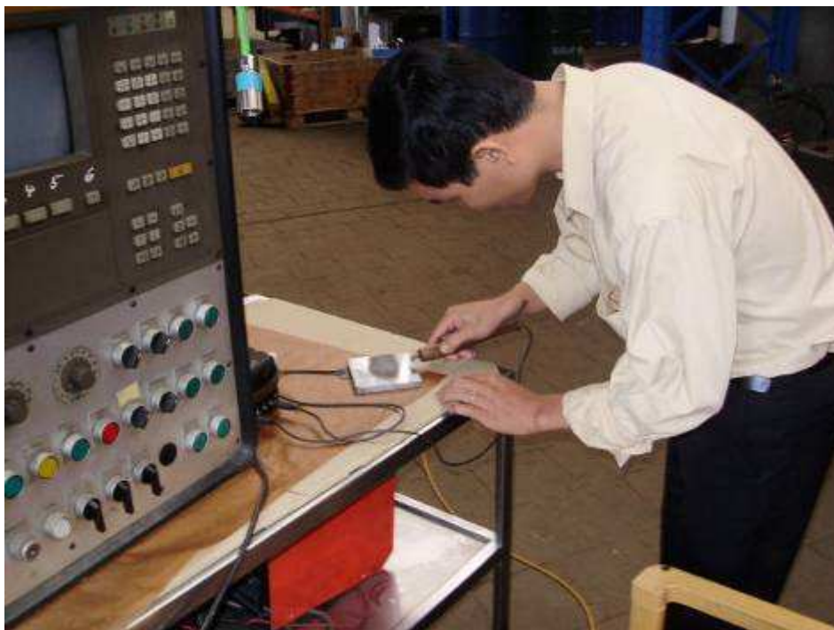
Photo: Hier noch beschriften. Man hat Elektroschreiben getestet und auch mit Schlagzahlen Versuche gemacht.
