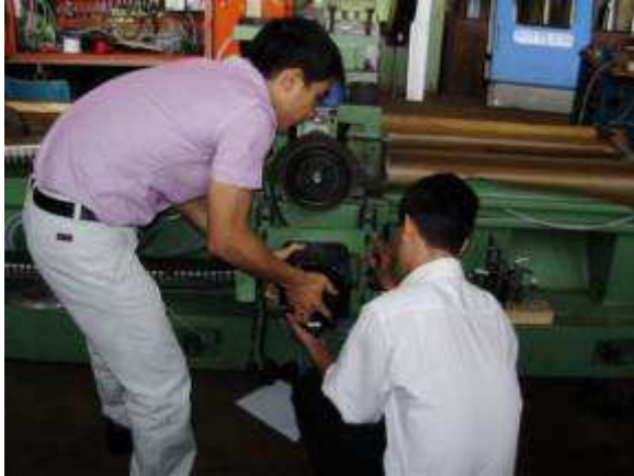
Photo: Taper Lok Montage, Konus ziehen und lösen
