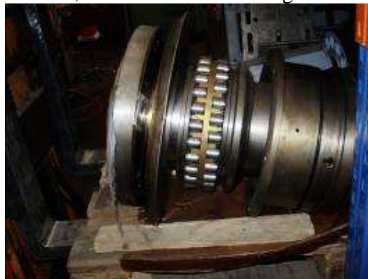
Photo: Die NN Lagerung ist für Schwer zerspannung
